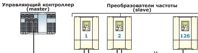
Рисунок 2.7 - Пример построения сети RS-485
